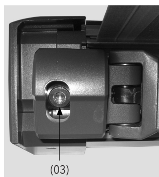
Abb. 15: Gelenkarmhalter mit Verstell-schraube (03)
