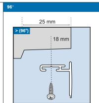
4.1a Seitenschiene verschrauben
