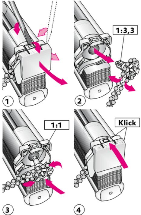
Typ K 160/250 - Getriebe wechseln
